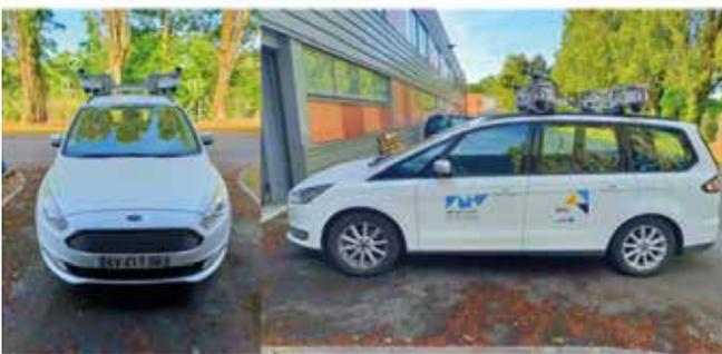
① Caméra PTZ haute résolution    ② LIDAR 3D Velodyne    ③ Radar Ultra Large Bande
