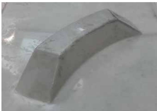
Démonstrateurs fabriqués (raidisseurs de forme T ou forme courbe en composites à renforts carbone ou verre et matrice polymère thermodurcissable ou thermoplastique)
